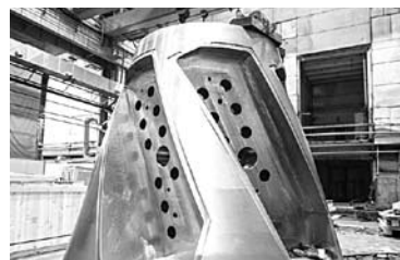
КОРПУС РАБОЧЕГО КОЛЕСА для Иркутской ГЭС готовится к совместной обработке с валом
